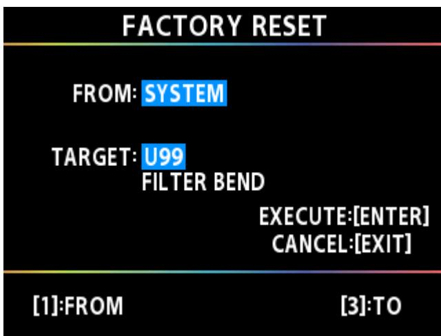
**5** Spécifiez la plage de réinitialisation d'usine en utilisant les molettes [1] et [3] pour régler <FROM> et <TO>.
