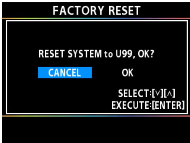
**7 Pour exécuter la réinitialisation d'usine, appuyez sur les boutons [V][A] et sélectionnez « OK », puis appuyez sur le bouton [ENTER] pour exécuter la réinitialisation d'usine.**
