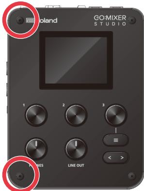
**2 Retirez les deux vis sur le côté droit de cet appareil.**
