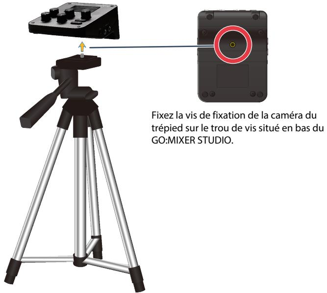
Fixez la vis de fixation de la caméra du trépied sur le trou de vis situé en bas du GO:MIXER STUDIO.
